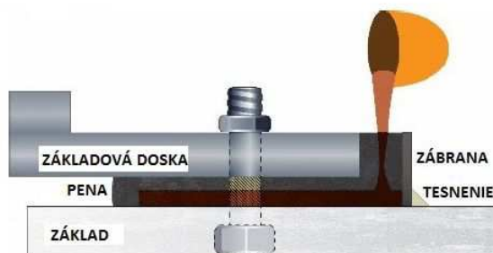
Obrázok 5 – Produkt Belzona® 7111 vyliaty tenkým prúdom.
