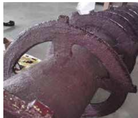
Závitkový dopravník s naneseným materiálom Belzona 1811
